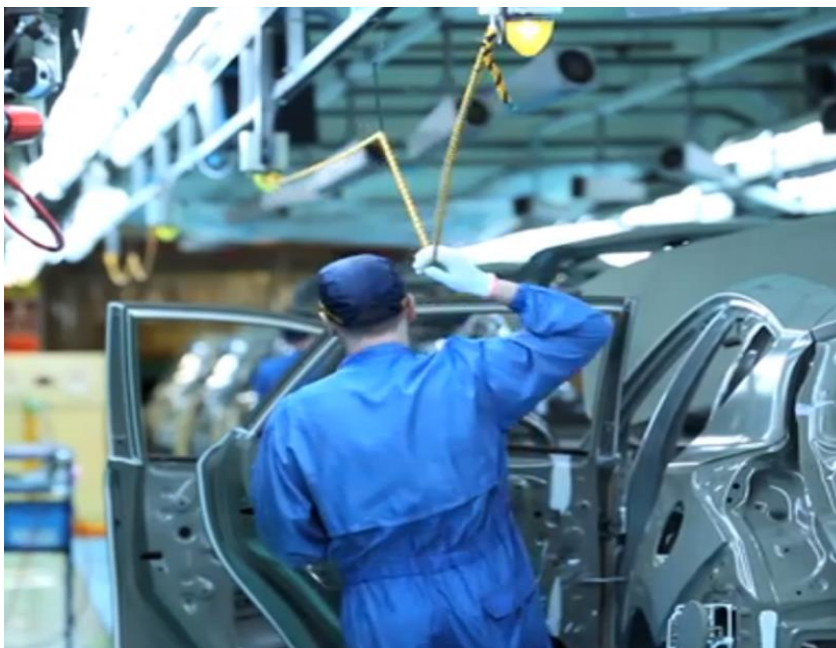
Εικόνα 2-4: Σχοινί Andon στην γραμμή παραγωγής [9]
