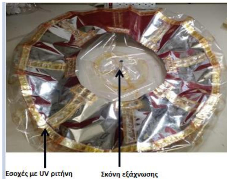
Εικόνα 76: Εσοχές του μπαλονιού όπου κυλάει η UV ρητίνη και δοχείο όπου αποθηκεύεται η σκόνη εξάχνωσης [46]
