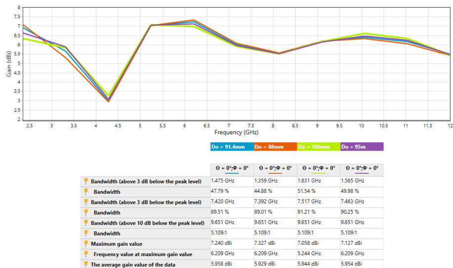
Διάγραμμα 28: Κέδρος ανα συχνότητα για διάφορες τιμές διαμέτρου
