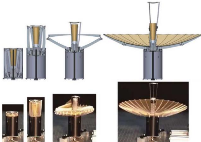
Εικόνα 64: Διαδικασία ανάπτυξης της κεραίας
