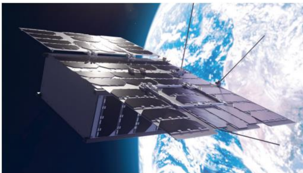
Εικόνα 23: Απεικόνιση CubeSat 6U - MilSpace2
