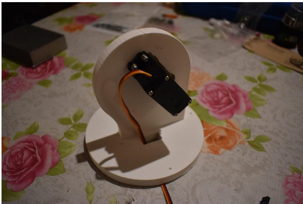
Εικόνα 26. Σύνδεση σερβοκινητήρα MG 996R στο επάνω μέρος της βάσης
