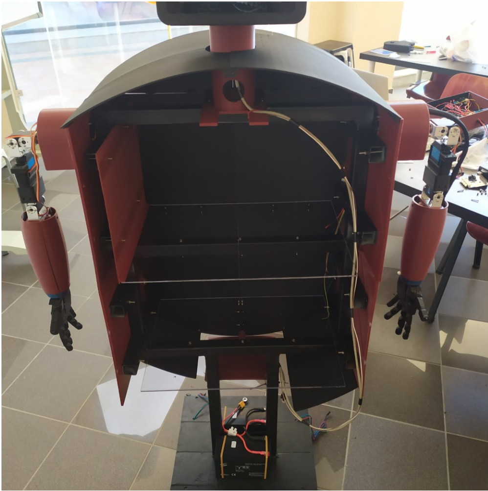
Εικόνα 25: Καλωδίωση διασύνδεσης πίνακα ηλεκτρονικών με κεφάλι
