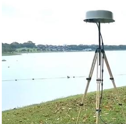
Εικόνα 23 Βήμα 1. Τοποθέτηση κεραίας ADFA στο πρώτο DF station
