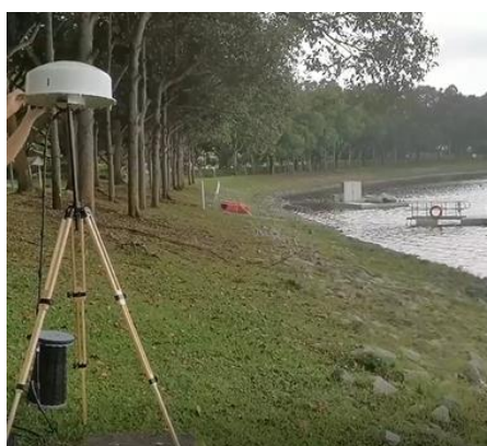
Εικόνα 24 Βήμα 2. Τοποθέτηση κεραίας ADFA στο δεύτερο DF station
