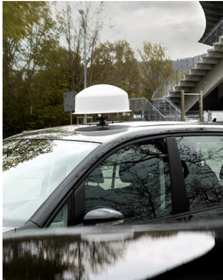
Εικόνα 19 Απεικόνιση κεραίας ADF4 με εφαρμογή στην οροφή αμαξιού και τα εσωτερικά της στοιχεία
