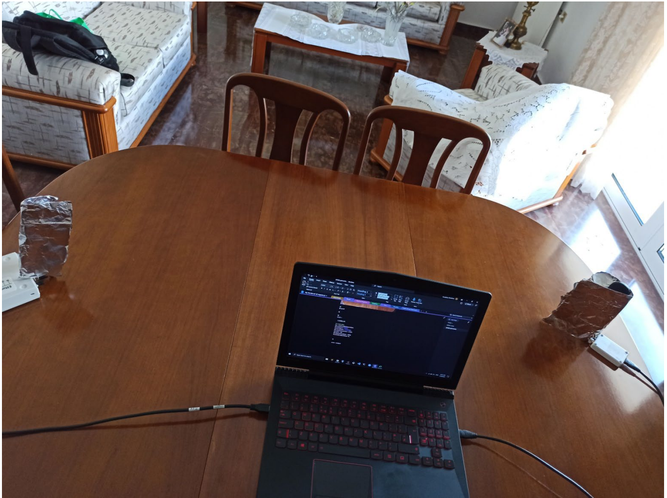
Εικόνα 6: Μετάδοση OFDM συμβόλου με την αφαίρεση του σκεδαστή.
