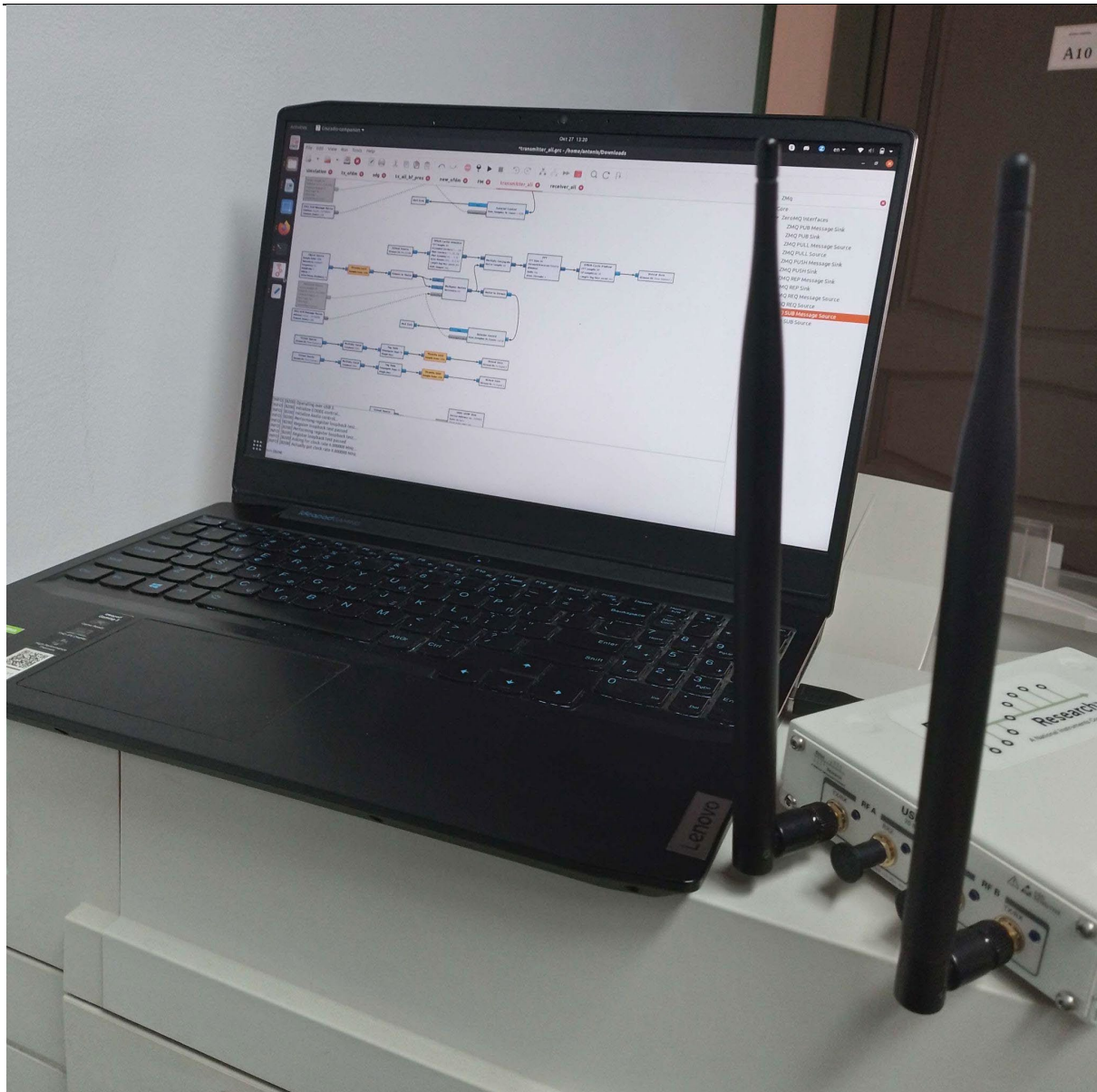
Εικόνα 5-13: Το σύστημα της Alice, Ettus B210 & Lenovo IdeaPad3
