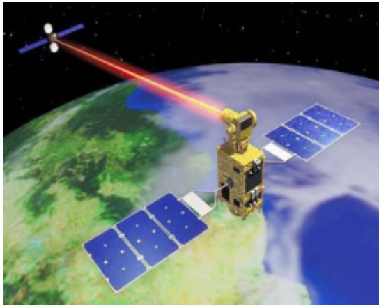
Εικόνα 1-2 :Επικοινωνία μεταξύ 2 δορυφόρων. Πηγή: A Review on Inter-Satellite Links Free Space Optical Communication
