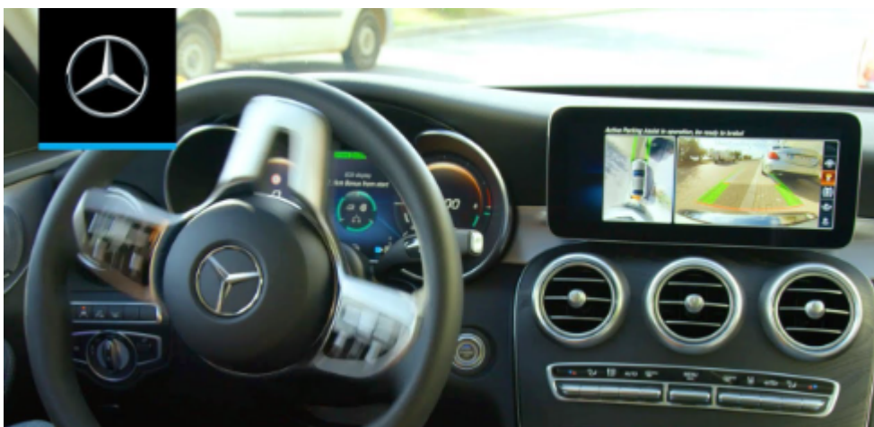
Σχήμα 7: Στη δίπλα εικόνα φαίνεται σε μια Mercedes A-200 η αυτόματη λειτουργία παρκκαρίσματος (Active Parking Assistant). [17]
