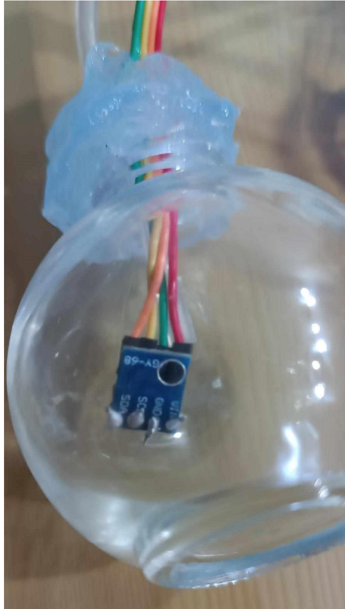
Εικόνα 40: Pressure Tank with BMP180 1
