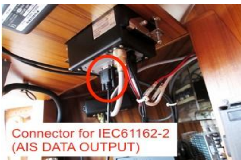
Εικόνα 16 «Σύνδεσμος για το IEC61162-2 για επικοινωνία δεδομένων AIS»[47]
