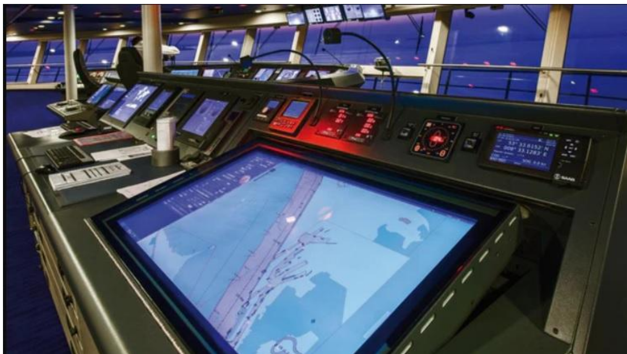
Εικόνα 11 ECDIS - Το σημείο κλειδί της σωστής πλοήγησης ενός πλοίου [31]
