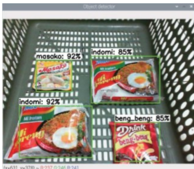
Εικόνα 13: Αναγνώριση αντικειμένων στο έξυπνο καλάθι που αναπτύχθηκε στα πλαίσια της εργασίας.
