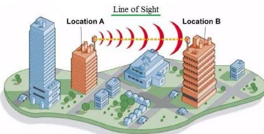
Εικόνα 3.3: Επικοινωνία μεταξύ δύο πομποδεκτών χωρίς να υπάρχει εμπόδιο μεταξύ τους (Line of Sight – LOS). [11]
